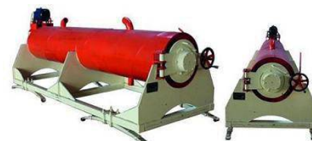
Centrifuge Machine (Sluce - opposite wrinkle single roll) with following technical specification: used in carpet washing factories: Approximate weight: 1500 kg. Dimensions: 125 * 380 cm. Motor power: 5/2 hp (4 kw - 1400 rpm) Sluce time: 7 min. مشخصات دستگاه آبگیر سانس یابوژ ضد چروک تک لوله: مورد استفاده در کارخانجات قالیشویی وزن تقریبی: ۱۵۰۰ کیلوگرم ابعاد: ۱۲۵ * ۳۸۰ سانتی متر قدرت موتور: ۵/۲ اسب بخار (۴ کیلو وات - ۱۴۰۰ دور در دقیقه) مدت آبگیری: ۷ دقیقه
